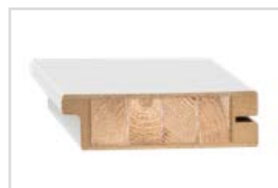
Rétegesen ragasztott függőleges fa tok, HDF és MDF lapokkal burkolva, felár ellenében rendelhető az alábbi dekorokhoz: FEHÉR PREMIUM, TÖLGY NATÚR PREMIUM, KŐRIS GRAFIT PREMIUM, JUHAR SZÜRKE PRÉMIUM, TÖLGY ST CPL
